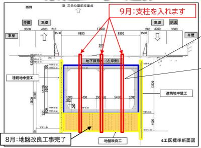
この支柱は地上で作業をする ための覆工板を支える柱です。 覆工板
